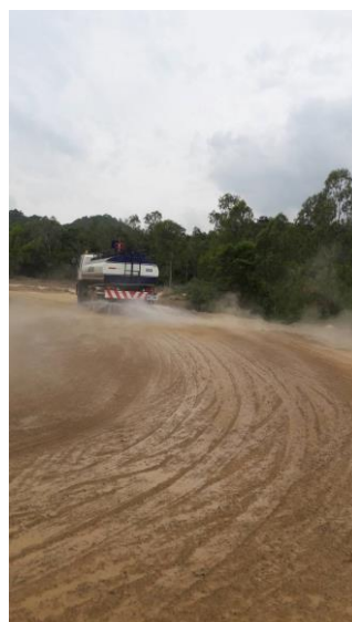
รูปที่ 5 การฉีดพรมน้ำบริเวณเส้นทางขนส่งแร่และบริเวณหน้าเหมือง
